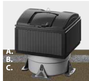
Kuva 1. Kuopan täyttäminen A. Viimeistelykerros, 100 mm B. Ankkurointikerros, sepeli 0/32, 400 mm C. Tasauskerros, murske 0/16, väh. 50 mm
