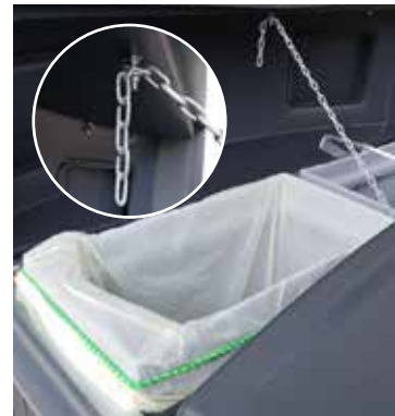
Kuva 5. Sivusaranan ketjun sekä kertakäyttöpussin asennus
